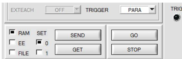
Der Zustand von IN0 wird auf der Oberfläche durch die LED **TRIG** angezeigt. Ist die LED schwarz, dann ist IN0=LO=0V und der Sensor arbeitet mit Parametersatz 0.
